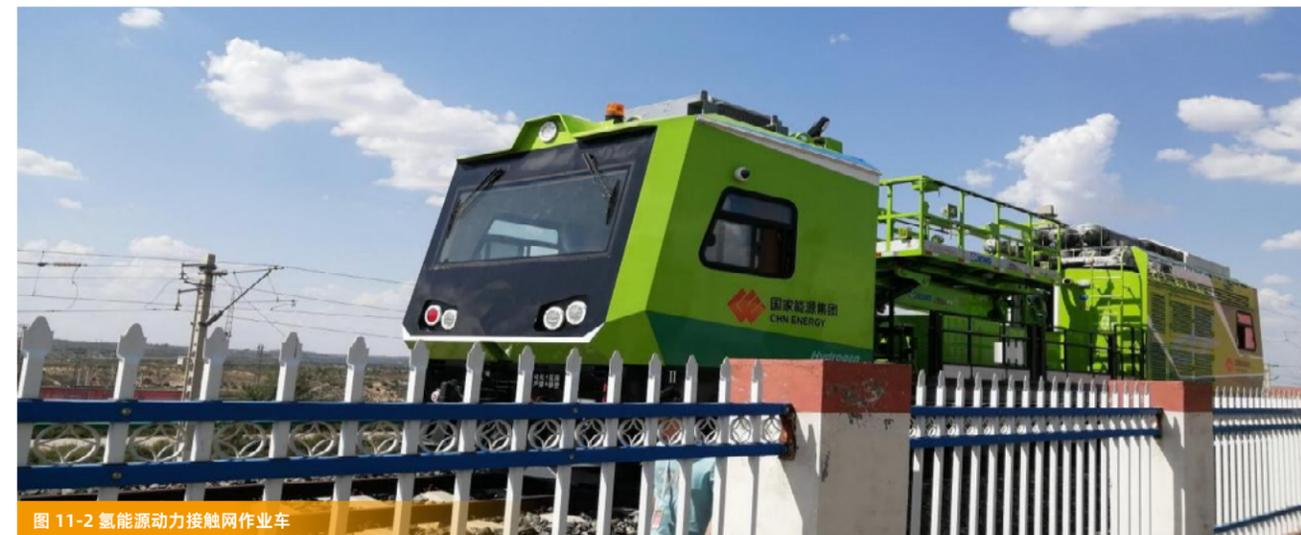
图 11-2 氢能动力接触网作业车
