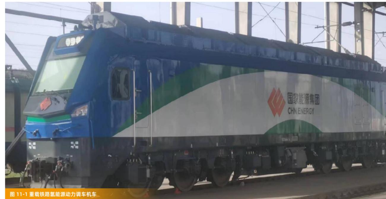
图 11-1 重载铁路氢能动力调车机车
